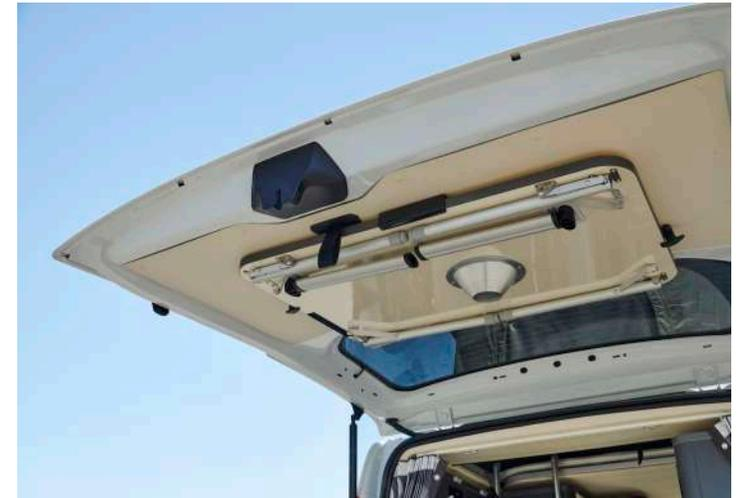
Unverzichtbar: Outdoor-Kit inkl. Tisch mit 4 Klappbeinen und höhenverstellbar. Der Tisch wird beim Kepler in der Schiebetür und beim Kelsey in der Heckklappe untergebracht. Zwei faltbare und platzsparende Sitze werden in einer Stoffhülle verstaut.
