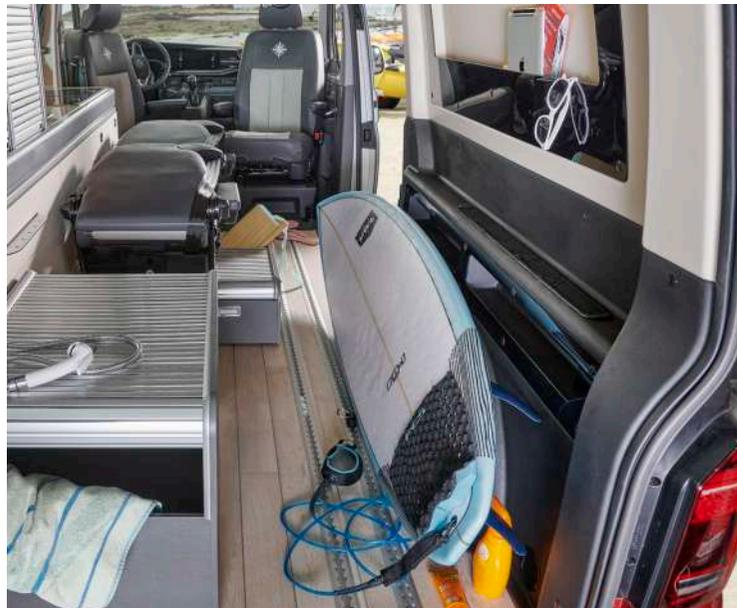
**Ein änderbarer Innenraum:** Die einzelnen Sitze, die auf Bodenschienen montiert sind, ermöglichen einen modularen Aufbau entsprechend der unterschiedlichen Einsatzmöglichkeiten.
