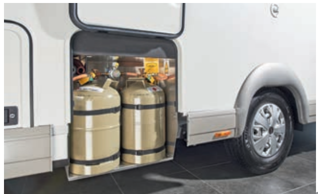
Gasflaschenkasten „easy change“ tief abgesenkt für ein bequemes Tauschen der Flaschen
