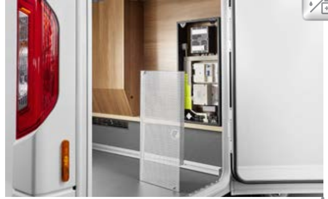
Elektrozentrale in der Rollergarage gut zugänglich
