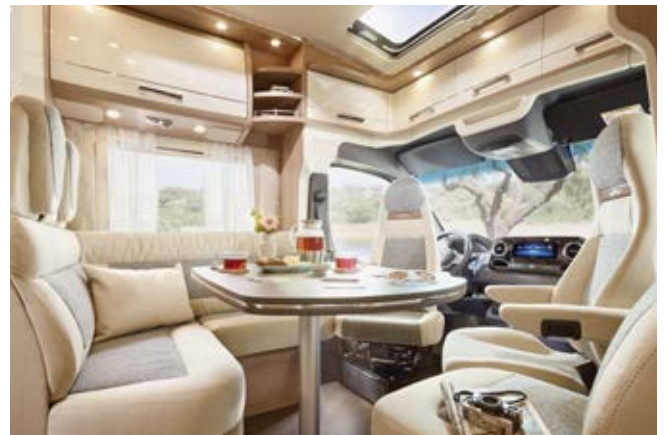
Rundumlaufende Dachstauschränke über dem Fahrerhaus mit viel Stauraum und indirekter Beleuchtung (Bild zeigt optionales Dachfenster „skyview“)
