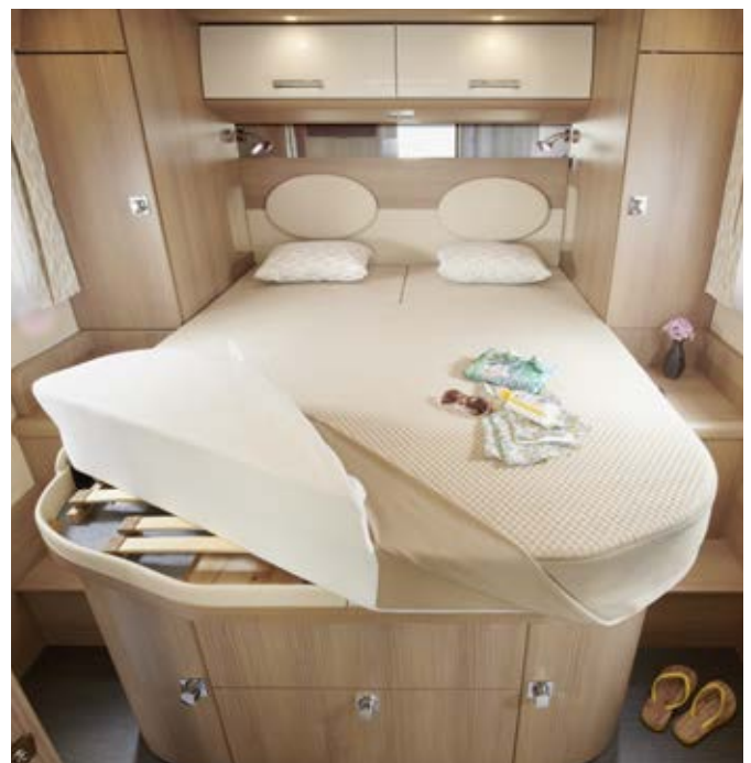
Wegklappbares Matratzenteil auf Beifahrerseite für extrabreiten Durchgang
