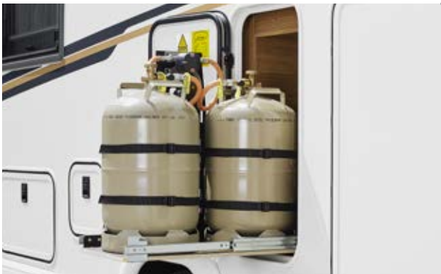
Gasflaschenkasten mit separater Außentür (T 143 LE). Optional: Komfort-Gasflaschenauszugssystem
