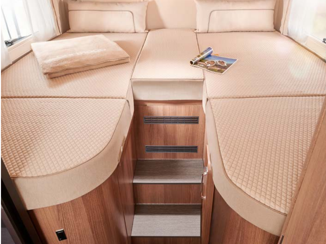
Große Längseinzelbetten mit aufstellbarem Kopfteil und ausziehbarer Komfort-Einstiegstreppe. Bequemer Zugang von vorn und oben zu darunterliegenden Kleiderschränken dank Liftfunktion (T 148 LE nur Fahrerseite).
