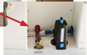
Wasserablasszentrale auch von außen durch die XL-Aufbautür bedienbar
