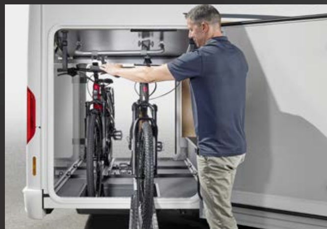
Leichte Beladung eines Pedelecs durch Einschubsystem mit einhängbarer Auffahrschiene
