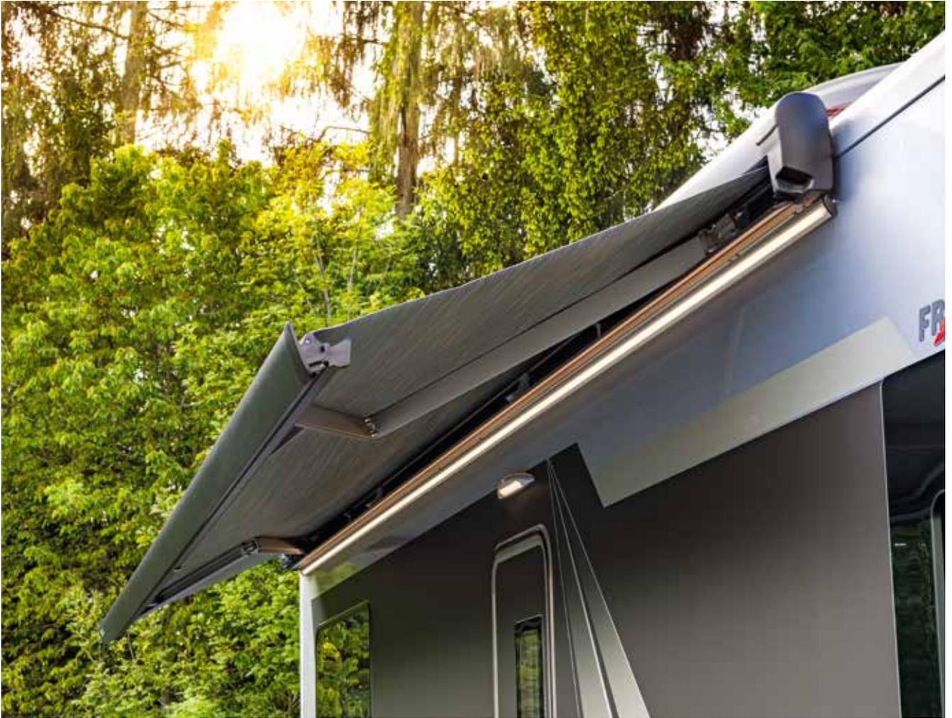
Markise - optional mit integriertem LED-Beleuchtungsprofil (Abbildung beispielhaft)
