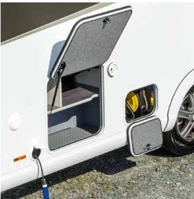
Selbstaurollende Kabeltrommel mit 15 m Kabel und Zentralversorgung
