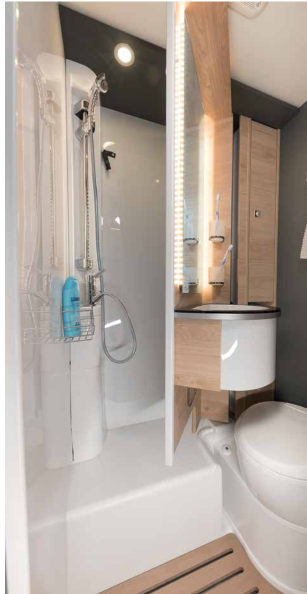
2 Zur Verwandlung in eine Duschkabine einfach Arretierung lösen und die Schwenkwand über die Toilette drehen.
