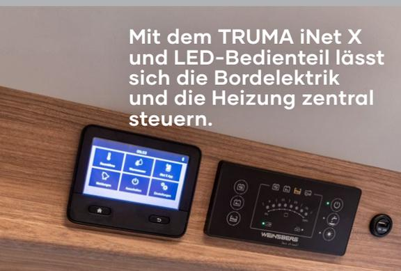
Mit dem TRUMA iNet X und LED-Bedienteil lässt sich die Bordelektrik und die Heizung zentral steuern.
