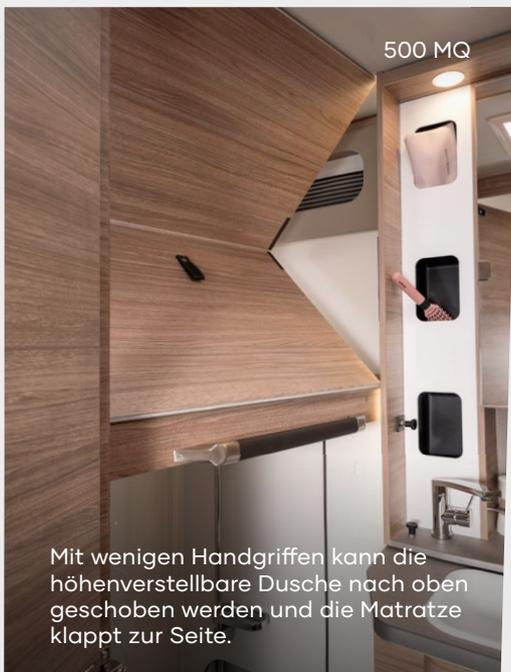
Mit wenigen Handgriffen kann die höhenverstellbare Dusche nach oben geschoben werden und die Matratze klappt zur Seite.
