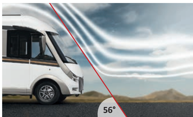
Dreidimensional geformte Front, flacher Anstellwinkel für weniger Luftwiderstand, reduzierter Kraftstoffverbrauch und weniger Windgeräusche
