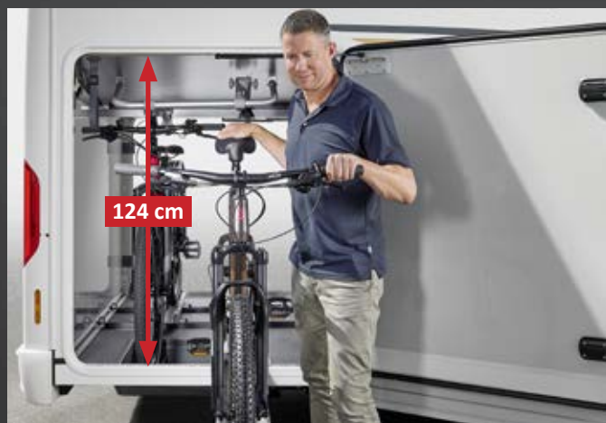
Erweiterung der Beladungshöhe durch einfaches Hochschwenken des innenliegenden Heckbetts mit einer Hand und zusätzlicher, abgesenkter Bodenmulde
