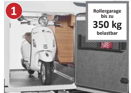
Rollergarage von bis zu 120 cm Innenhöhe durch tiefe Absenkung, beidseitiger Zugang über zwei große Rollergaragentüren auf Fahrer- und Beifahrerseite
