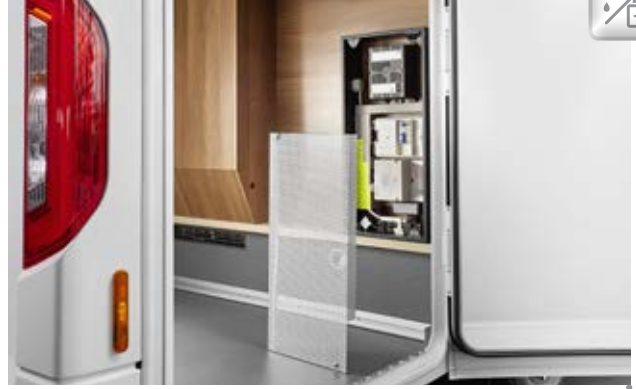
Elektrozentrale in der Rollergarage gut zugänglich
