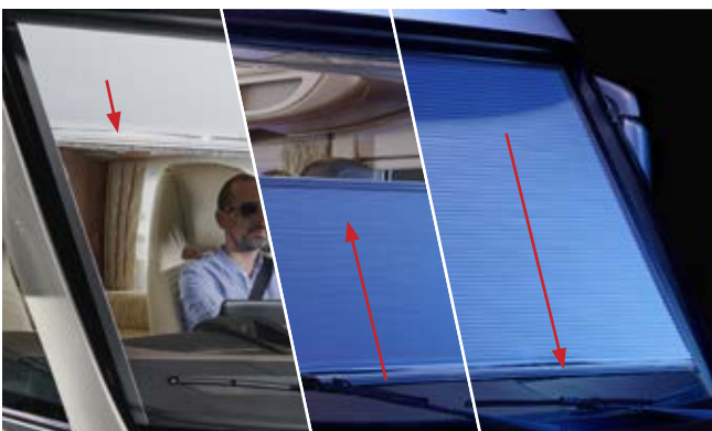
Elektrisches Frontscheibenplissee mit individuell programmierbarer Privacy- und Sonnenblendfunktion (ab Baureihe chic e-line)
