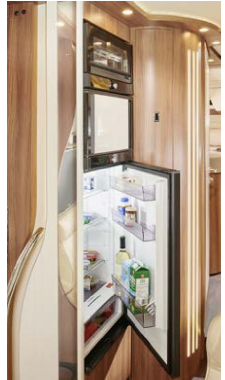
153-l-Kühlschrank mit beidseitiger Türöffnung und separatem Gefrierfach
