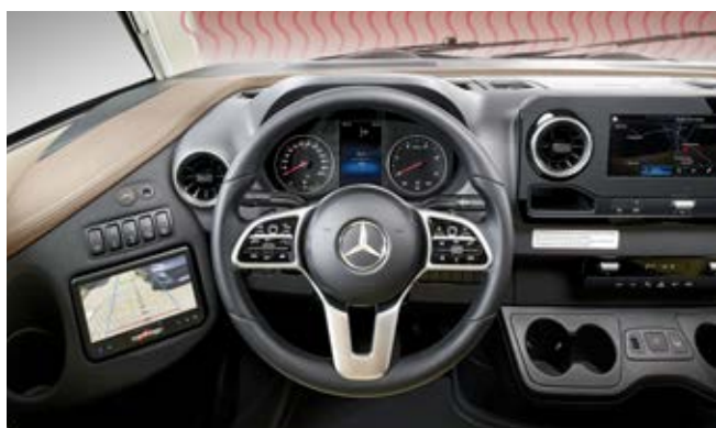
Fahrsicherheit: übersichtlich und funktional gestaltet, Wärmeabstrahlung in den Fahrerhausbereich durch beheizte Armaturenbrettoberfläche
