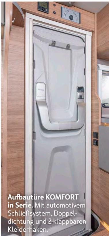
**Aufbautüre KOMFORT in Serie.** Mit automotivem Schließsystem, Doppel-dichtung und 2 klappbaren Kleiderhaken.
