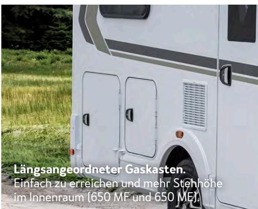
**Längsangeordneter Gaskasten.** Einfach zu erreichen und mehr Stehhöhe im Innenraum (650 MF und 650 ME).
