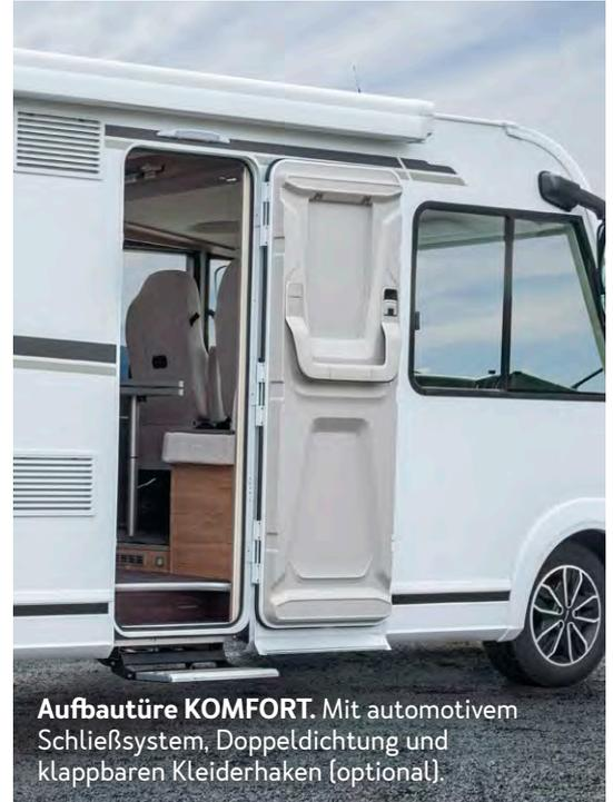
**Aufbautüre KOMFORT.** Mit automatischem Schließsystem, Doppeldichtung und klappbaren Kleiderhaken (optional).
