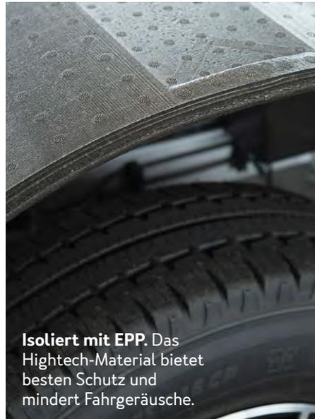
**Isoliert mit EPP.** Das Hightech-Material bietet besten Schutz und mindert Fahrgeräusche.
