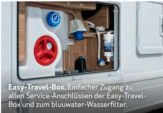
**Easy-Travel-Box.** Einfacher Zugang zu allen Service-Anschlüssen der Easy-Travel-Box und zum bluuwater-Wasserfilter.
