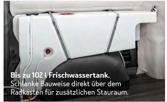
**Bis zu 102 l Frischwassertank.** Schlanke Bauweise direkt über dem Radkasten für zusätzlichen Stauraum.
