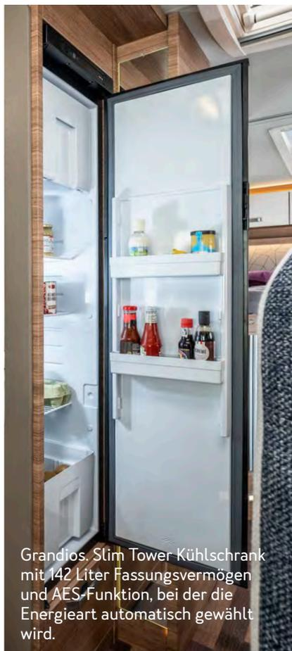
Grandios. Slim Tower Kühlschrank mit 142 Liter Fassungsvermögen und AES-Funktion, bei der die Energieart automatisch gewählt wird.
