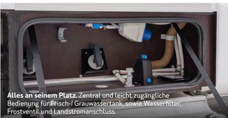
**Alles an seinem Platz.** Zentral und leicht zugängliche Bedienung für Frisch-/ Grauwassertank, sowie Wasserfilter, Frostventil und Landstromanschluss.
