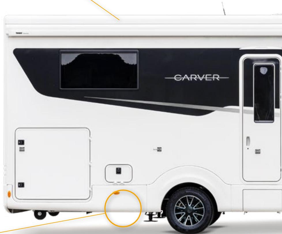
Auch mobile Eigenheime benötigen einen stabilen Grund. Dafür sorgen robuste Maschinenbauschrauben, die den unteren Boden des Chassis kraftvoll sichern.
