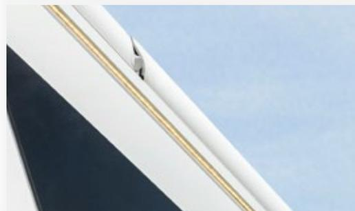
Die Klappen werden über das Concorde Aluminium-Scharnierband mit Gummiseele geöffnet. Dank dieser intelligenten Lösung läuft selbst im geöffneten Zustand kein Wasser zwischen der Seitenwand und den Klappen hindurch..
