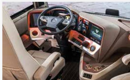
Serienmäßig sorgen Notbremsassistent und Spurhalteassistent für Ihre Sicherheit. Das Radarsystem des Notbremsassistenten erkennt Hindernisse und greift bei fehlender Fahreraktivität ein. Die Kamera des Spurhalteassistenten hilft dem Fahrer beim Einhalten der Fahrspur.
