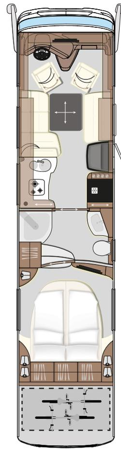
Multivariable Garage für PKW von einer Länge bis zu 4,30 m und maximalem Gewicht von 1.400 kg. Individuelle Prüfung notwendig.
