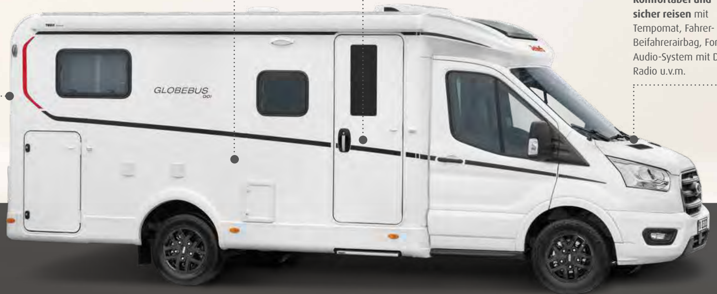
Dach, Heck und Seitenwände aus widerstandsfähigem GFK.
