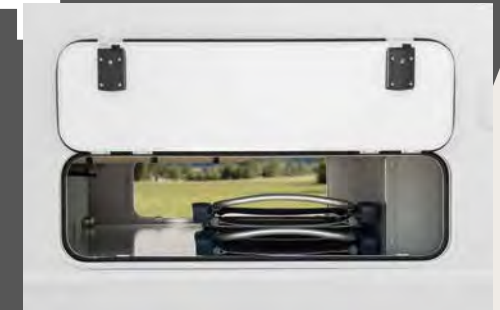
Frostgeschützt: beheizter Doppelboden mit viel Stauraum.
