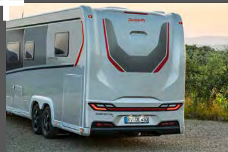
Automotiv ausgeformtes GFK-Heck mit bester Isolation und formschöner Integration von Rückfahrkamera und dritter Bremsleuchte.
