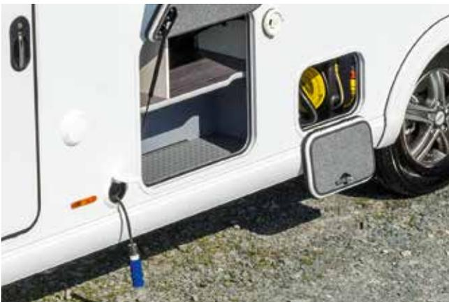
Selbstaufrollende Kabeltrommel mit 15 m Kabel und Zentralversorgung
