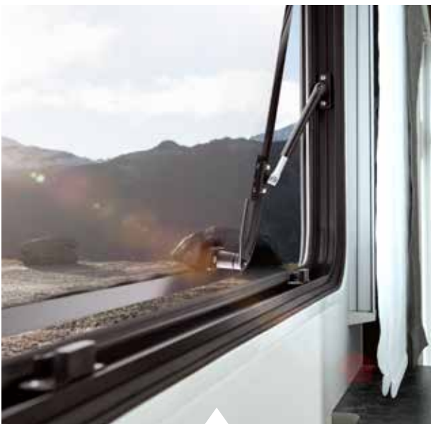
Echtglasfenster im Wohnraum Doppelverglast und getönt.
