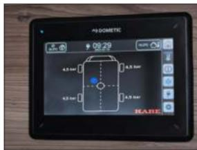
KABE Smart Level. KABE Smart Level wird im Smart D Bedienpanel angezeigt und enthält drei praktische Funktionen. Smart Level überwacht den Gasfüllstand (serienmäßig für eine Gasflasche, keine Kunststoff-Gasflasche), den Reifendruck und die Neigung des Wohnmobils (Serienmäßig im Imperial).
