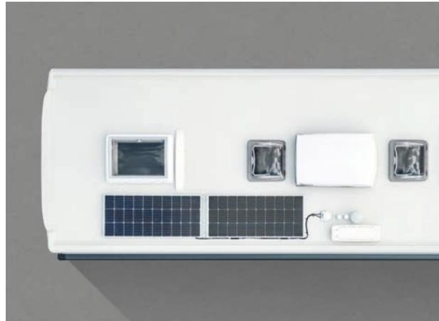
SOLARANLAGE MIT CA. 280 W MAXIMALER LEISTUNG
